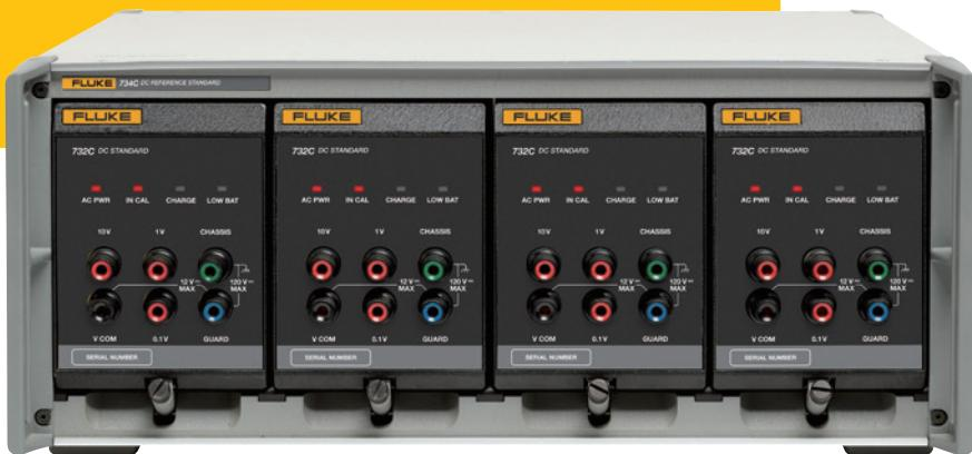
福禄克计量校准部的734C是符合RoHS标准的直流电压参考和传递标准，用于维护一级和二级标准实验室中的标准伏特电压。该参考标准由四个电气和机械完全独立的732C直流电压参考标准和一个机架宽度的机箱组成。每台732C均具有10V、1V和0.1V输出，可轻松携带或运输至全国各地的校准实验室，也可以在本地校准实验室内维护。标准型号的稳定度指标为10V输出时， $\pm 2\mu\text{V/V}$ 每年；1V输出时， $\pm 3\mu\text{V/V}$ 每年；0.1V输出时 $\pm 9.8\mu\text{V/V}$ 每年。精选型号是福禄克计量校准部最新提供的选择，10V输出时，其稳定度优于标准型号两倍。它的每路10V输出可驱动高达12mA电流，即使低输入阻抗仪器也可简单配合使用。
